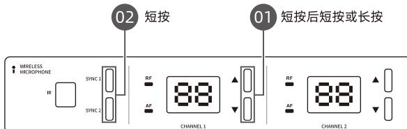
同一时间内只会有一个通道在音量调整模式，若此时已有另一个通道在音量调整模式，则只需要短按当前想要音量的通道的控制按键即可切换至当前通道的音量调整模式。
