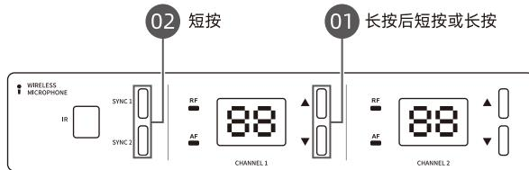
同一时间内只能有一个通道在频率切换模式，若此时已有另一个通道在频率切换模式，则短按当前想要切换频率的通道的控制按键即可切换至当前通道的频率切换模式。
